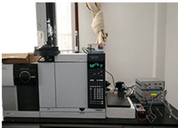
GC-MS-EAD 色谱 - 质谱 - 昆虫触角电位联用系统
